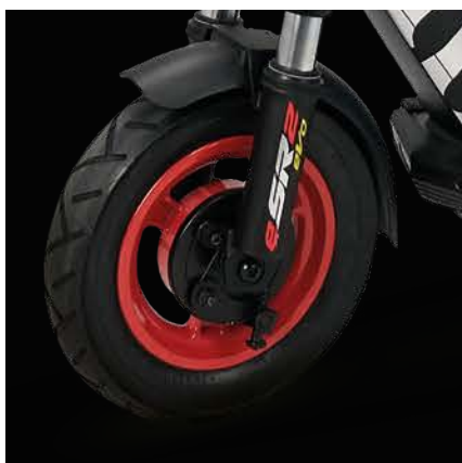
Pneus 10" avec chambre à air
